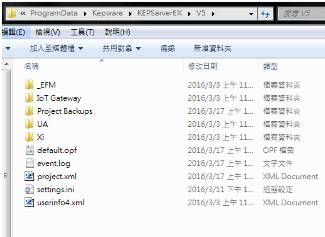
●當 KEPServerEX 為 Stop Runtime 狀態，改為 Runtime 狀態時，便自動抓取並套用 project.xml 檔，並將該 xml 檔刪除。
