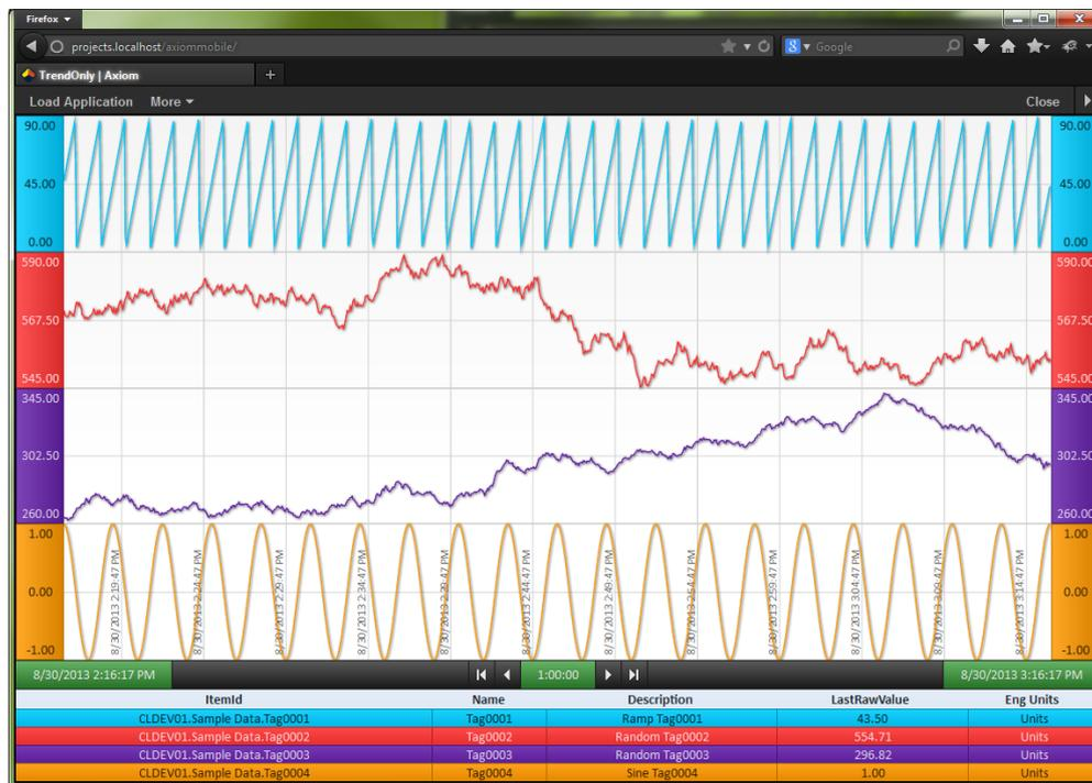
AxiomTrend™ 是一個直覺式和易於使用的 Client 端資料分析工具。它能視覺化地將您的製程資料轉化為可以用來改善製程的知識，以提高品質並增強營運效率。它讓操作員，工程師和管理人員使用共通的分析工具，在任何時間任何地點檢視即時和歷史的製程資料。AxiomTrend™ 使資料可輕易地檢視。您可輕易且快速地以您想要的格式來對於趨勢資訊進行檢視、分析和報表製作。趨勢資料可被傳送到桌上型電腦中的一個標準的應用程式，或是傳送到一個瀏覽器的 Web 應用程式。
